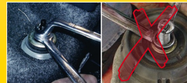
Nicht an der Härteverstellung gegenhalten, beim Anziehen der Kolbenstangenmutter
