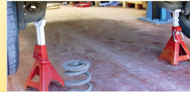
Das angehobene Fahrzeug absichern
