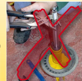
Greifen Sie nie mit einer Zange auf die Kolbenstange
