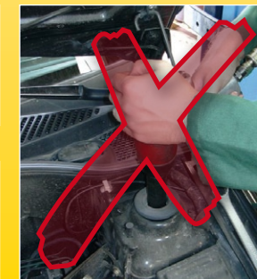
Verwenden Sie nie einen Schlagschrauber zum Befestigen der Kolbenstangenmutter
